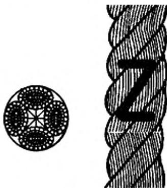
Рисунок 2 — Конфигурация 4-рядного крученного каната (тип В)
