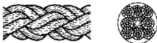
Рисунок 3 — Конфигурация 8-рядного плетеного каната (тип L)
