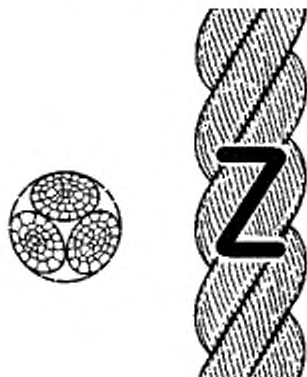
Рисунок 1 — Конфигурация 3-рядного крученного каната (тип А)
