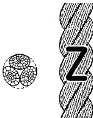
Рисунок 1- Конфигурация 3-рядного крученого каната (тип А)
