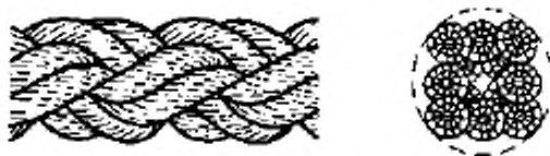
Рисунок 3- Конфигурация 8-рядного плетеного каната (тип L)
