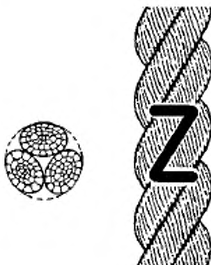
Рисунок 1- Конфигурация 3-прядного крученого каната (тип А)
