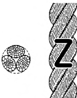
Рисунок 1 — Конфигурация 3-рядного крученого каната (тип А)
