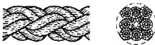
Рисунок 3 — Конфигурация 8-рядного плетеного каната (тип L)
