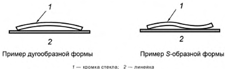
Рисунок 8 — Измерение отклонения от прямолинейности кромок
