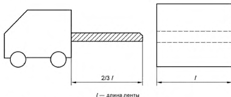
Рисунок 6 — Предпочтительный способ использования автопогрузчика с приспособлением в виде носовой штанги
